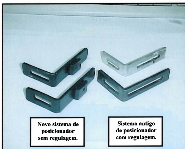
Figura 10: Posicionadores de curso da Rosqueadeira, Novo sistema de posicionador sem regulagem (esquerda da figura) e Antigo sistema posicionador com regulagem (direita da figura).
